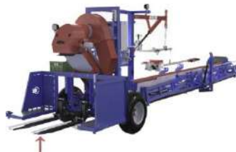
Elevador Hidráulico de Palets
